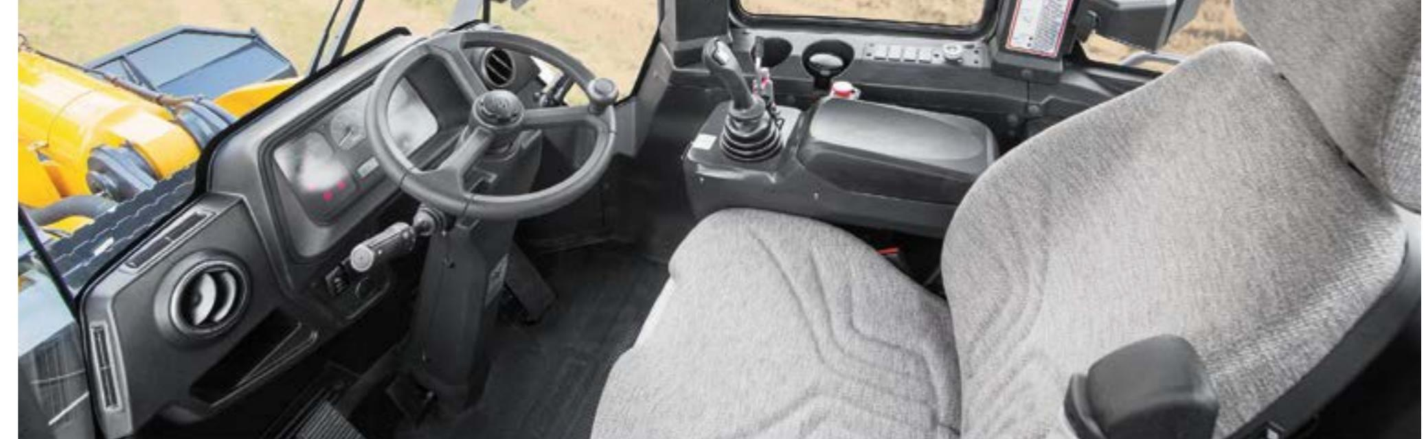
Кабина обеспечивает защиту оператора от шума и вибраций и хорошо вентилируется. Современная система климат-контроля гарантирует комфорт в любое время года, а герметизация кабины предотвращает попадание пыли.
